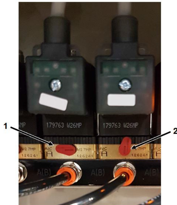
Fig. 0-128 Tvangsstyrning af luftaktuatorer for ventiler
