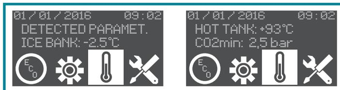
Si la dernière icône à droite **"ALARMES ET ENTRETIENS"** est sélectionnée, elle indique le temps résiduel avant l'épuisement du filtre et de la lampe UV (si installés et programmés). Elle indique aussi les jours qui manquent avant la prochaine "Désinfection" (si programmée).
