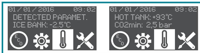
El último icono a la derecha **"ALARMAS y MANTENIMIENTO"**, cuando está seleccionado, señala cuánto falta para que se agote el filtro y la lámpara UV (si están instalados y configurados). Señala también cuántos días faltan para el siguiente "Saneamiento" (si está configurado).
