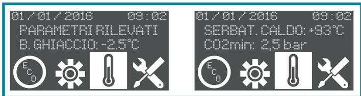
L'ultima icona a destra "**ALLARMI e MANUTENZIONI**" quando è selezionata segnala quanto manca all'esaurimento del filtro e lampada UV (se installati ed impostati). Segnala anche quanti giorni mancano per la prossima "Sanificazione" (se impostata).
