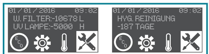
Wenn einer dieser Parameter sich dem Fälligkeitstermin nähert bzw. andere Funktionsstörungen vorliegen, blinkt das entsprechende Symbol und das Display zeigt die zu treffenden Maßnahmen an.
