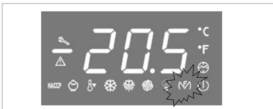
Este LED indica el estado (encendido o apagado) de las RESISTENCIAS PUERTA
