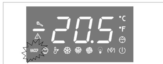
Ce LED indique un état d'alarme HACCP.
