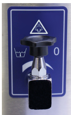
Fig. 0-105 Ventil for kondensat ud
