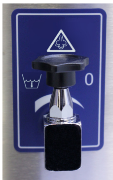
Fig. 0-108 Ventil for kondensat ud
