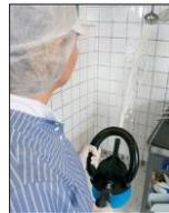
9. Afstanden fra injektorens dyserør til rengøringsoverfladen skal være minimum 50 cm.
