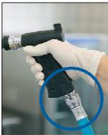
7. Vandslange med 1/2" lynkobling (varenr. 5350SA3) sættes på pistolens nippel.
