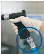
7. Le tuyau avec raccord rapide 1/2" (article n° 5350SA3) est raccordé à l'embout du pistolet à eau.
