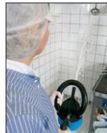
9. La distance entre l'embout des buses de l'injecteur et la surface à nettoyer doit être de 50cm minimum.
