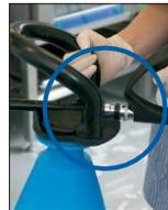
6. Le pistolet à eau (article n° 53105A1 ou 40801A3) est raccordé à l'embout de l'injecteur.
