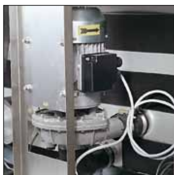
Förbättrad hygien med självtömmande pumpar i disk- och sköljzoner.
