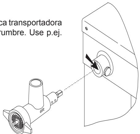
Caso que la rosca transportadora se haya atascado cuando hay que desmontar la picadora de carne, ésa puede sacarse colocando un gancho o una herramienta parecida en el agujero del árbol de la rosca transportadora.
