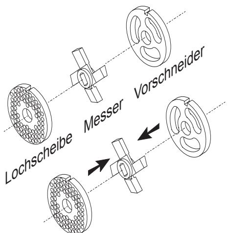
Das Messer soll ausgetauscht oder geschliffen werden, wenn die Reibflächen der Seite des Messers **1mm** übersteigen. Falls dies versäumt wird, kann die Rührmaschine beschädigt werden, da die frktion im Fleischwolf erhöht wird wenn das Messer abgenutzt ist.
