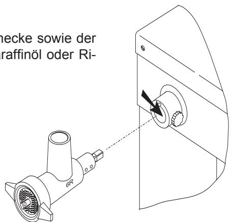
Falls die Schnecke steckenbleibt, wenn der Fleischwolf zerlegt werden soll, kann sie ausgezogen werden durch Einsetzen eines Hakens oder eines ähnlichen Werkzeuges ins Loch der Schneckenwelle.
