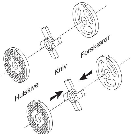
Kniven skal udskiftes eller slibes, når slidfladerne på siden af kniven overstiger **1mm**. Undlades dette, kan det forårsage skade på røremaskinen, da friktionen i kødhakkeren øges, når kniven er slidt.
