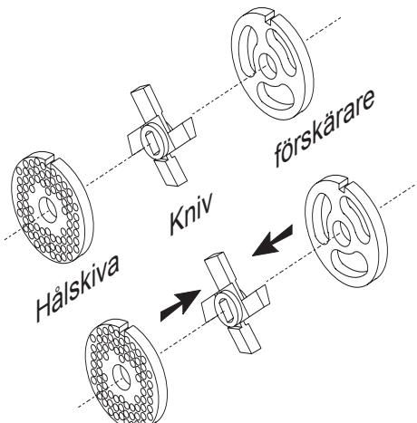
När kniven ska slipas igen eller bytas ut, bör hela sättet slipas eller bytas ut. Kniven skall bytas ut eller slipas, när slitytorna på knivens sida överstiger **1 mm**. Om detta inte görs, kan det förorsaka skada på mixern, eftersom friktionen i köttkvarnen ökas när kniven är sliten.
