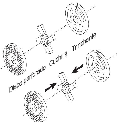
La cuchilla ha de reemplazarse o afilarse cuando la superficie de desgaste en el costado de la cuchilla supere 1 mm. Si se deja de realizar esto puede ocasionar daños en el mezclador ya que la fricción en la picadora de carne se aumenta cuando la cuchilla está desgastada.
